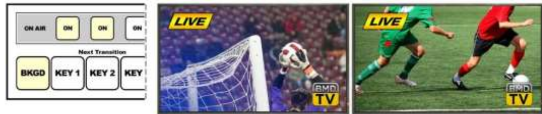
La section Next Transition du Signal de sortie du programme avant la transition. Signal de sortie du programme après la transition. panneau de contrôle avant la transition.
