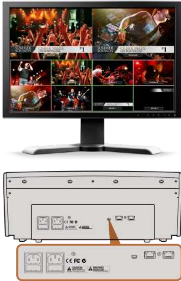
Connecteurs situés à l'arrière de l'ATEM 1 M/E Broadcast Panel
